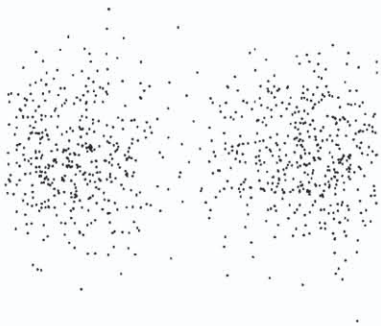
图 3 BPSK (SNR = 4dB) Fig. 3 BPSK (SNR = 4dB)
