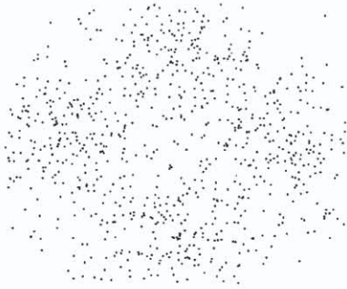
图 4 QPSK (SNR = 4dB) Fig. 4 QPSK (SNR = 4dB)
